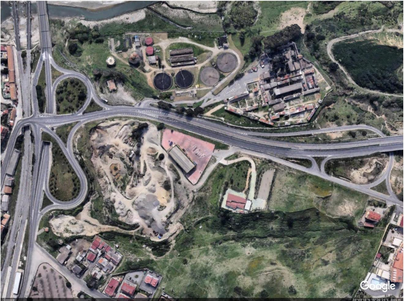
La soluzione progettuale, prevede di inserire nell'attuale svincolo Nalini, una intersezione a rotatoria, del tipo previsto dalla normativa vigente, avente un diametro esterno di circa mt. 47 nella quale sono state previste anche le banchine (delle quali una sormontabile).
